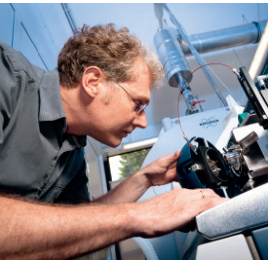
Thorsten Dittmar öffnet die Injektions-einheit des Massenspektrometers. Aus der Spritze am rechten Bildrand gelangt die Probe über die rot ummantelte Kapillare in die Injektionsquelle.
