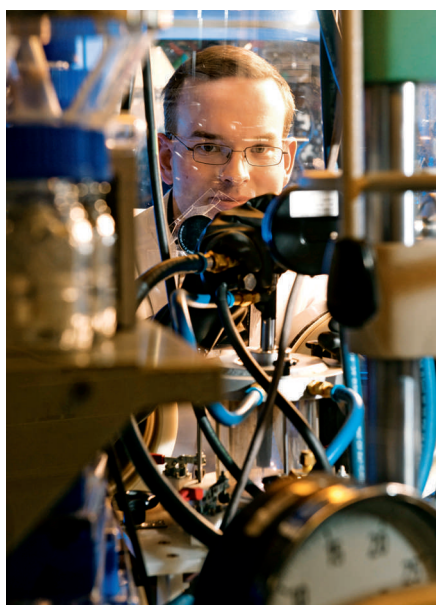
Neue Verbindungen erzeugt Bodo Böhme oft im Lichtbogenofen (links). Doch er und seine Kollegen testen auch andere Synthesemethoden (rechts): Hier präsentiert Böhme einen Probenbehälter, in dem die pulverförmigen Ausgangsstoffe liegen. Sie werden von einem Gas überströmt und reagieren zu der Zielverbindung.
