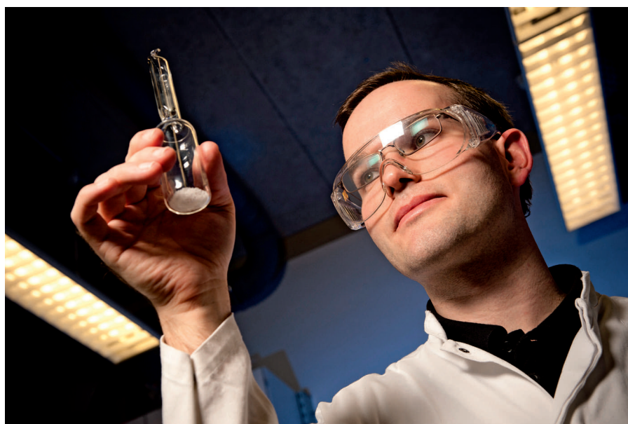
Neue Verbindungen erzeugt Bodo Böhme oft im Lichtbogenofen (links). Doch er und seine Kollegen testen auch andere Synthesemethoden (rechts): Hier präsentiert Böhme einen Probenbehälter, in dem die pulverförmigen Ausgangsstoffe liegen. Sie werden von einem Gas überströmt und reagieren zu der Zielverbindung.
