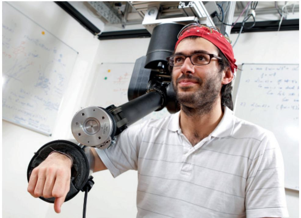
Eine Sache der Konzentration: Manuel Gomez Rodriguez übt, den Roboterarm mithilfe seiner Gehirnströme zu dirigieren. Elektroden leiten die Befehle direkt aus seinem Gehirn ab.
