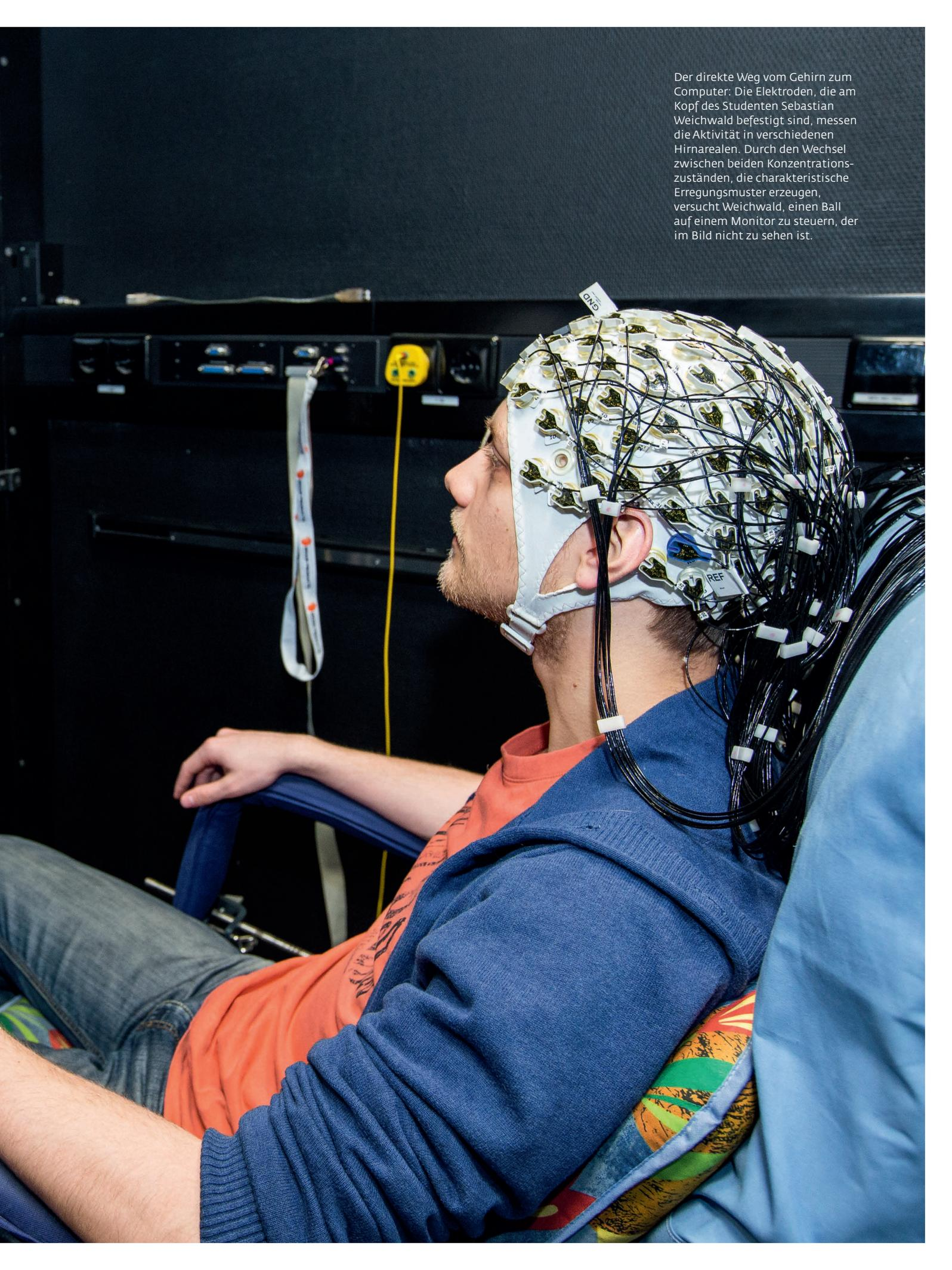
Der direkte Weg vom Gehirn zum Computer: Die Elektroden, die am Kopf des Studenten Sebastian Weichwald befestigt sind, messen die Aktivität in verschiedenen Hirnarealen. Durch den Wechsel zwischen beiden Konzentrationszuständen, die charakteristische Erregungsmuster erzeugen, versucht Weichwald, einen Ball auf einem Monitor zu steuern, der im Bild nicht zu sehen ist.
